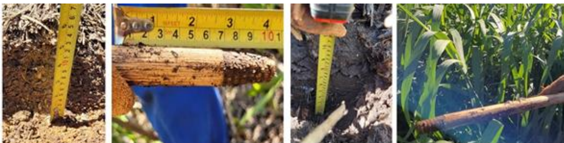
Figura 5 – Medição da camada de lodo durante a operação do WL e análise da consistência
