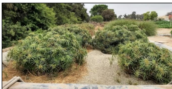
Figura 9 – Fito Filtro, área esquerda com camada de palha e serragem, área direita sem camada
