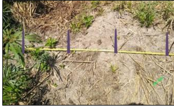
Figura 5 – Chinchá 2022: medição da camada de lodo acumulada na superfície ao longo do tempo
