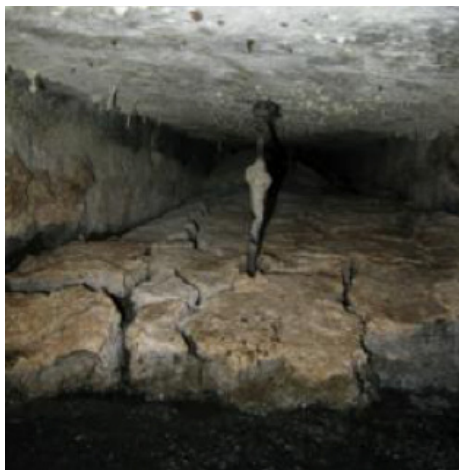
Figura 3.13: Foto do separador trifásico rompido por conta da obstrução, pela espuma, da tubulação de saída do biogás.
