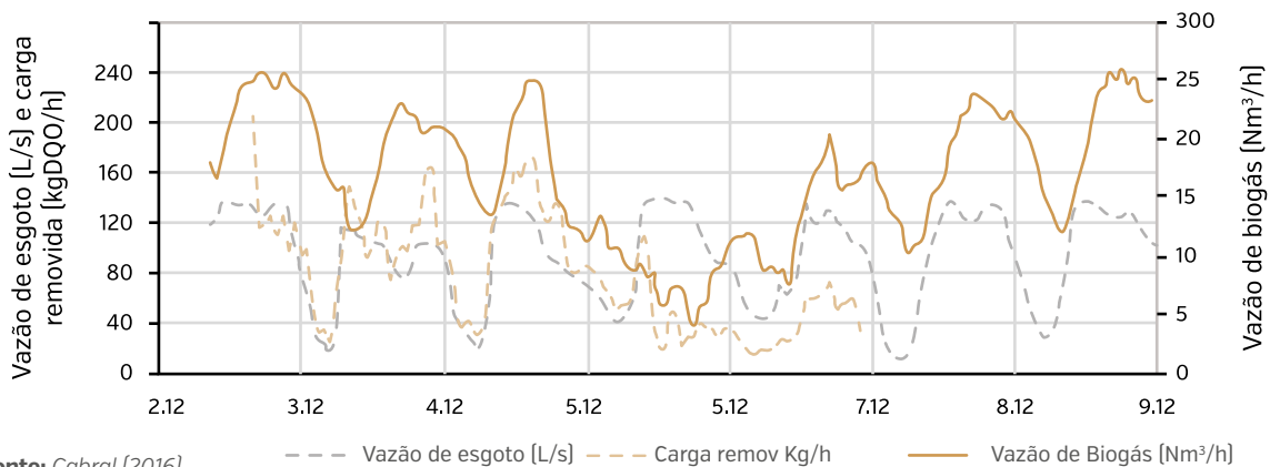
Figura 49: Médias horárias da vazão de esgoto e biogás e carga de DQO removida na ETE C - período chuvoso.
