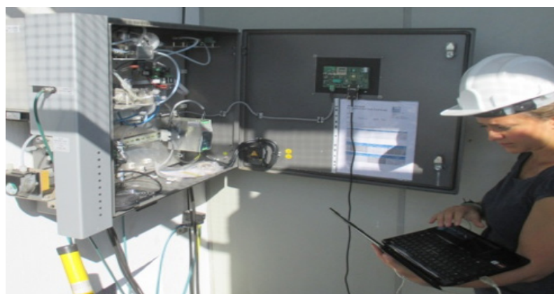
Figura 7: Calibração do medidor de composição de biogás em campo, realizada pela Rotária do Brasil.
