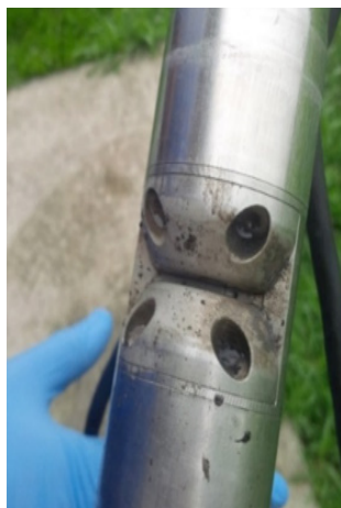
Figura 10: Carbo::lyser antes de limpeza manual.
