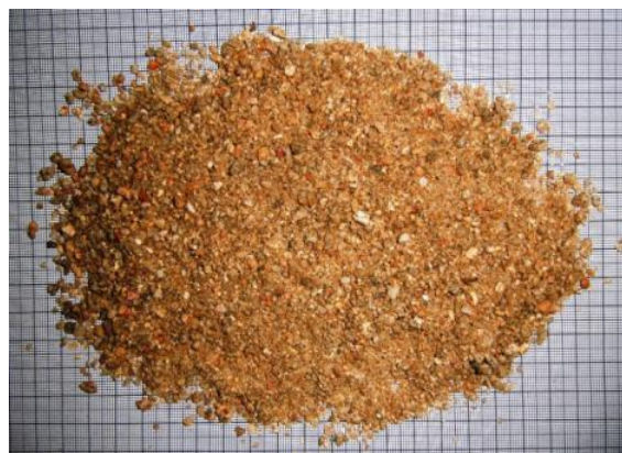
Figura 8. Arena gruesa utilizada para un HFV para el tratamiento de aguas residuales en Brasil, arena del río sin polvo, barro o arcilla (foto H. Hoffmann, 2009).
